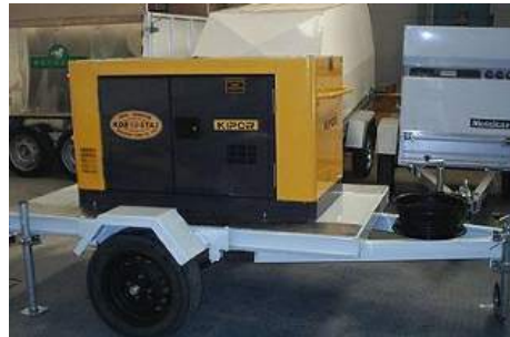
GRUPO ELECTRÓGENO AUXILIAR
